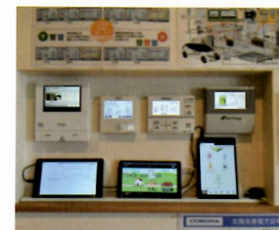
AIを搭載したHEMSが家庭の電気を最適にコントロール
