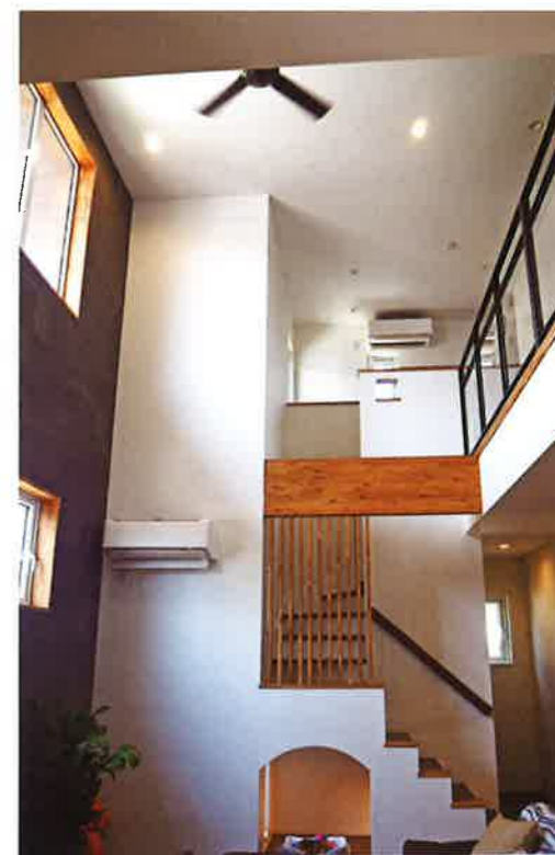
高断熱・高気密設計で、床から天井までムラのない室温環境。冬は1階、夏は2階のエアコン1台で全館空調。
